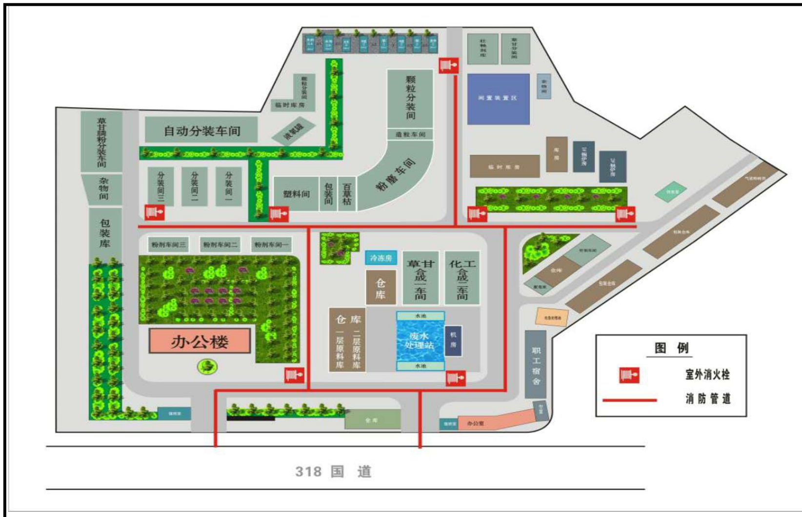
图 4-7 厂区消防管道布置图
